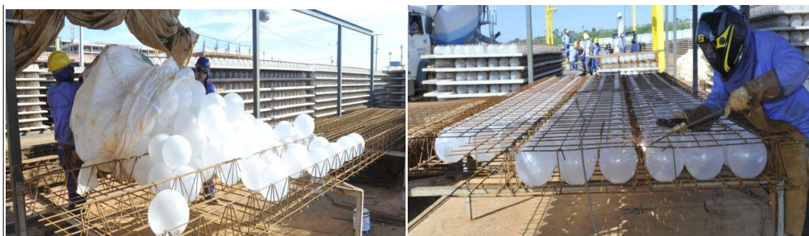
شکل ۶- تولید شبکه پنل BubbleDeck در کارخانه
